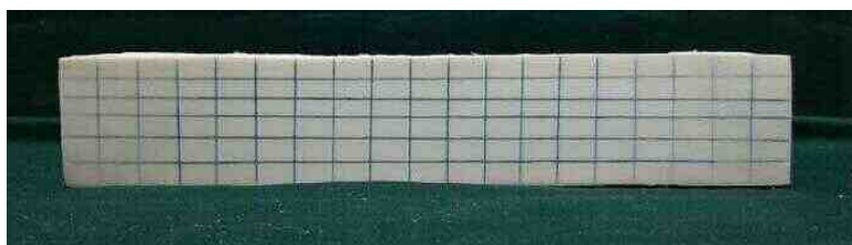
Figura 28 – Protótipo de Flexão em Vigas.
