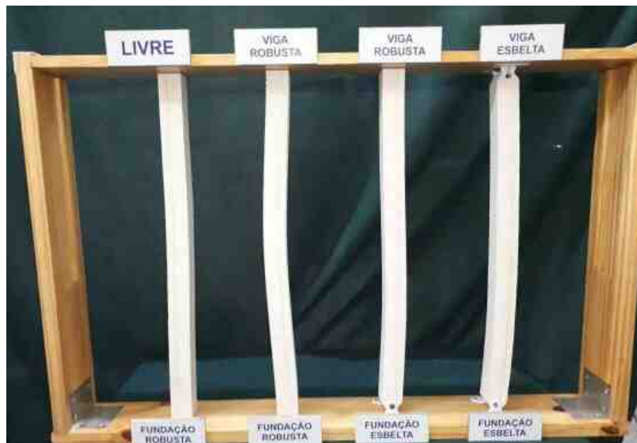
Figura 27 – Peça de Flambagem com molduras auxiliares
