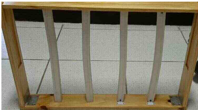
Figura 9 – Peça que irá ilustrar o efeito de flambagem em execução
