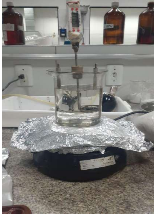
Figura 15 - Montagem do ensaio de ponto de amolecimento
