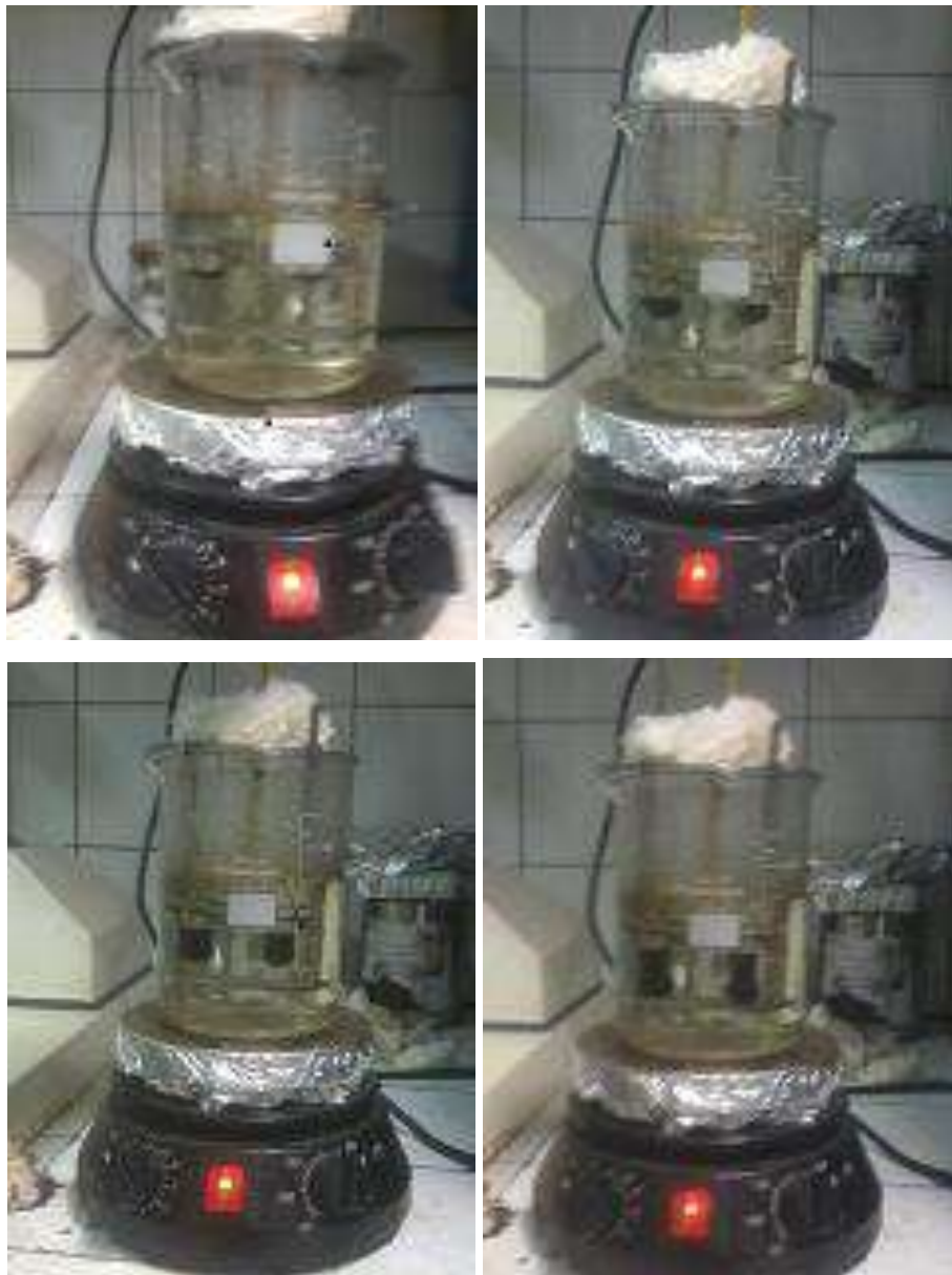
Figura 6 – Momento em que é medido o ponto de amolecimento
