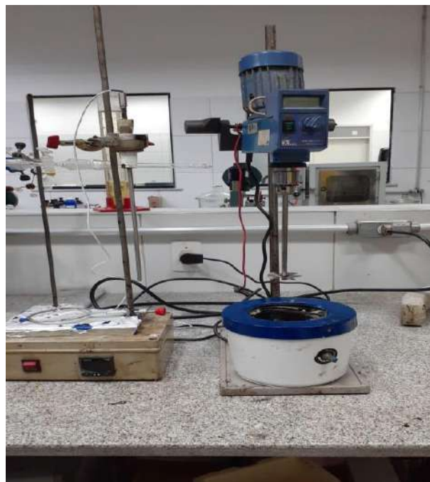
Figura 13 - Misturador utilizado na incorporação da sacola plástica ao ligante
