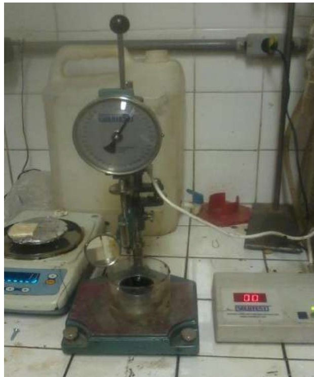
Figura 14 - Equipamento Utilizado para Penetração (LMP).
