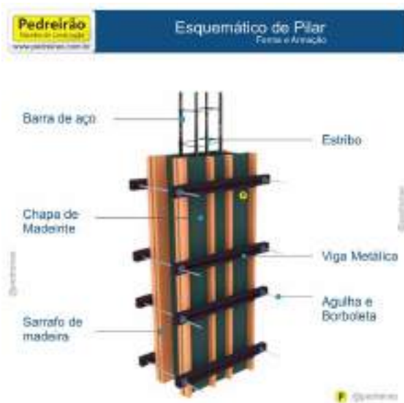
Figura 19- Esquema de montagem de pilar
