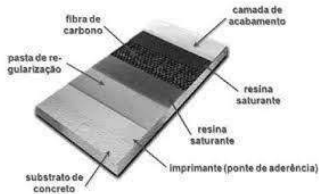
Figura 10- Etapas construtivas dos sistemas compostos estruturados com fibras de carbono
