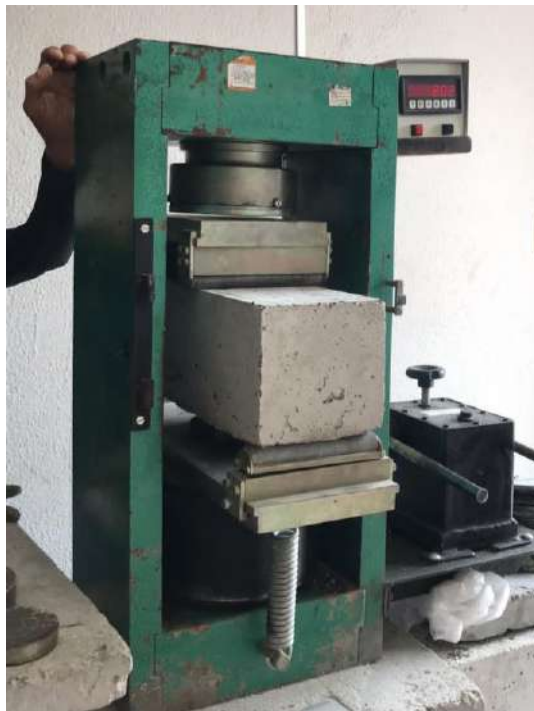
Figura 10 – Ensaio de resistência à tração na flexão
