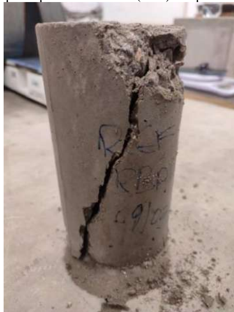
Figura 12, – Corpo de prova referencial (REF) rompido à compressão axial
