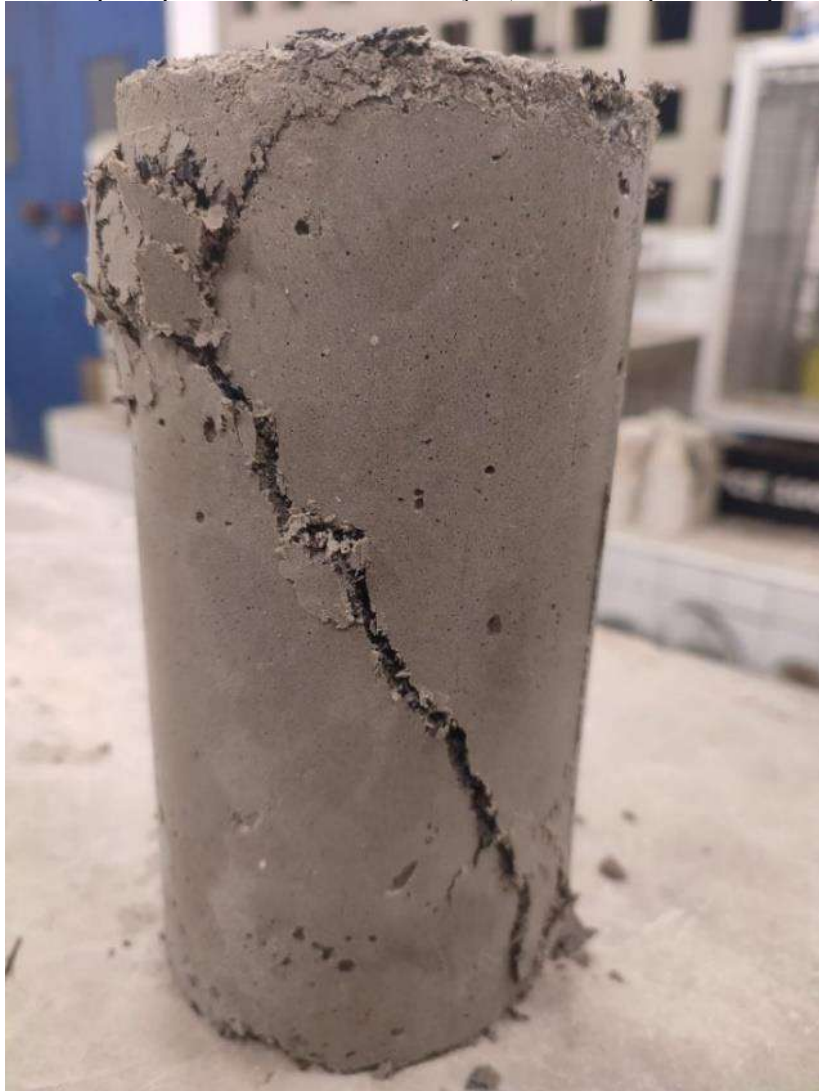
Figura 13 – Corpo de prova com 25% de substituição (25RBP) rompido à compressão axial
