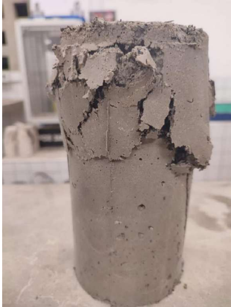
Figura 14 – Corpo de prova com 50% de substituição (50RBP) rompido à compressão axial
