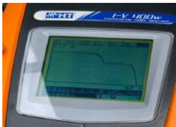
Figura 17 – Curva I-V da placa sem manutenção.
