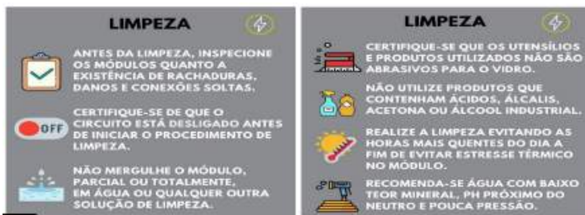
Figura 19 – Limpeza do sistema.
