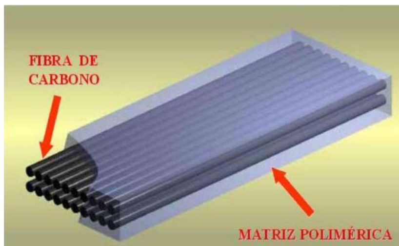
Figura 10 – Matriz Polimérica da Fibra de Carbono
