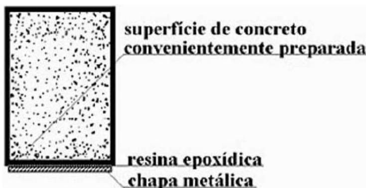
Figura 13 - Viga com Reforço na Face Inferior com Chapas de Aço
