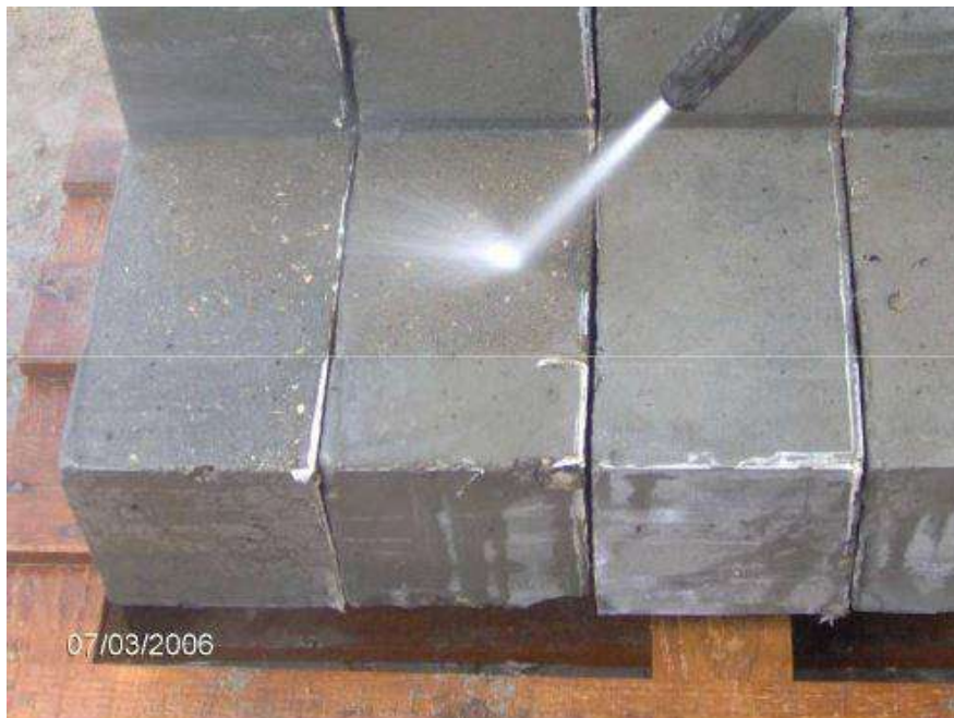
Figura 3 – Preparação da Superfície com Jato de água
