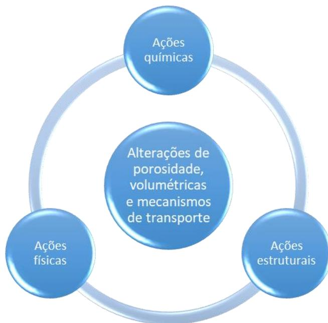
Figura 1: Representação esquemática das interações do meio ambiente com a estrutura interna do concreto (COMMITTEE on CONCRETE DURABILITY, 1987 apud HELENE, 1993).
