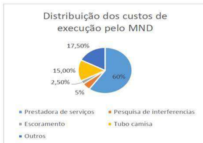
Figura 19 – Distribuição de custos de execução pelo MND
