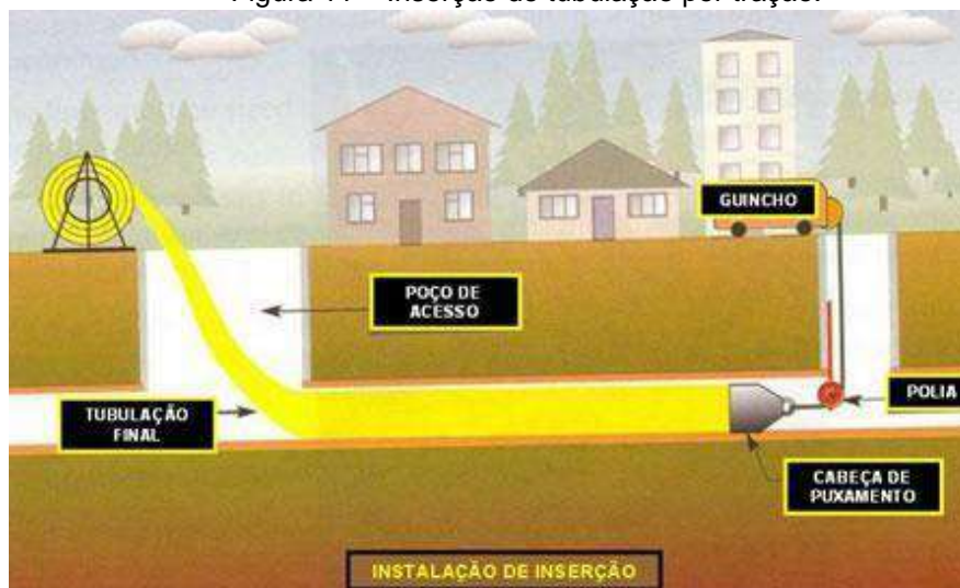
Figura 11 – Inserção de tubulação por tração.
