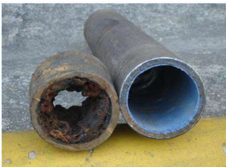
Figura 10 – Tubo reabilitado do aplicação de resina epóxi.
