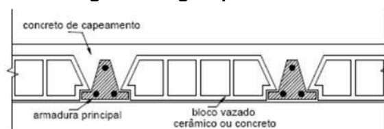
Figura 9 - Vigota pré-moldadas.
