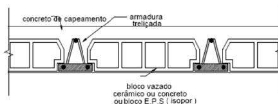
vigota com armadura treliçada (VT)
