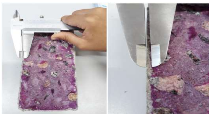
Figura 11 - Medição da profundidade de carbonatação
