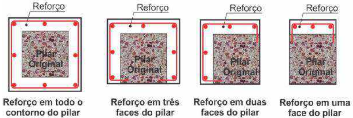
Figura 22 - Disposição das variadas formas de aumento da seção transversal.
