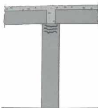
Figura 5 - Fissuras de assentamento plástico.
