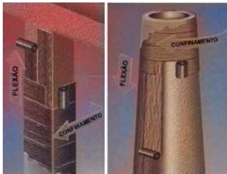
Figura 41 - Aplicação da manta para reforço para flexão e reforço para confinamento.
