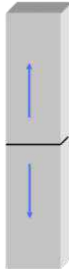
Figura 15 - Fissuras causadas por tração.
