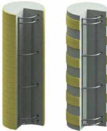
Figura 36 - Pilar reforçado com encamisamento contínuo (esquerda) e discreto (direita).
