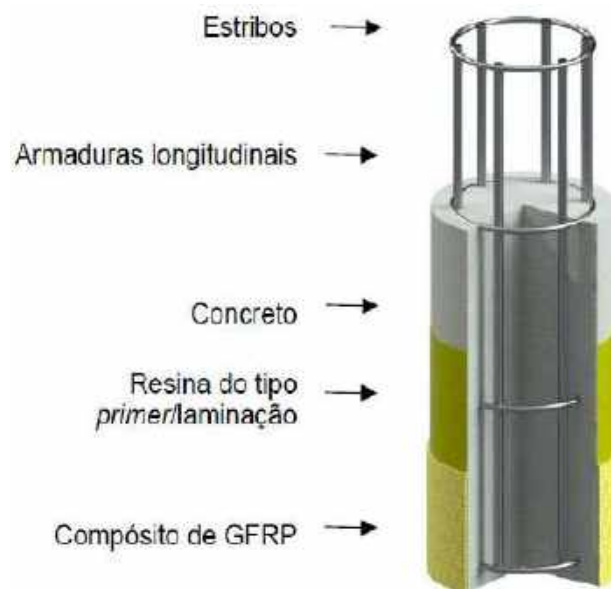
Figura 35 - Camadas de um pilar reforçado com FRP.
