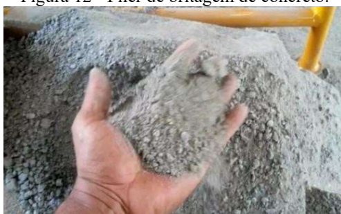
Figura 12 - Fíler de britagem de concreto.
