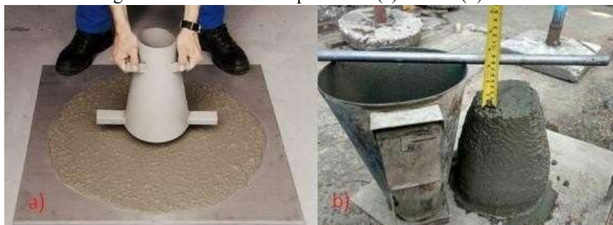
Figura 1 - Ensaio de Slump Test em (a) CAA e (b) CCV
