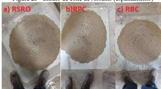
Figura 25 - Ensaio de cone de Abrams (espalhamento)
