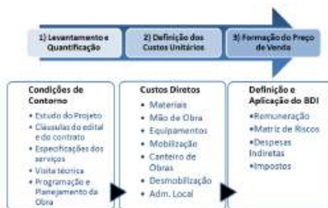
Figura 03: O processo de orçamentação de obras
