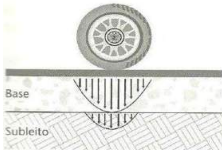
Figura 9 - Resposta Mecânica do Pavimento Flexível
