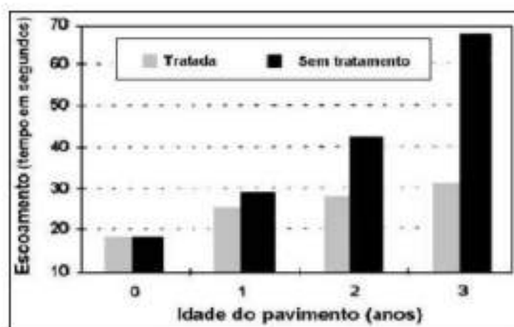
Figura 36 - Estudo realizado nas Rodovias Espanholas mostrando a Evolução da Colmatação entre Pavimentos
