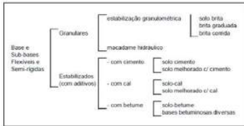
Figura 7 - Constituição das bases e sub-bases flexíveis e semirrígidas
