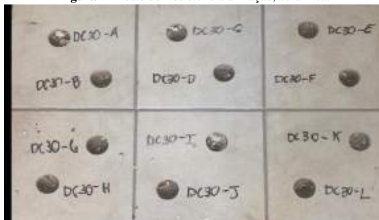
Figura 7 - Teste de Resistencia a Tração, cerâmica.
