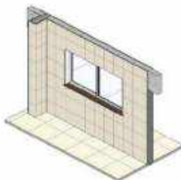
Figura 9 – LOD 500: Elemento de Parede arquitetônica
