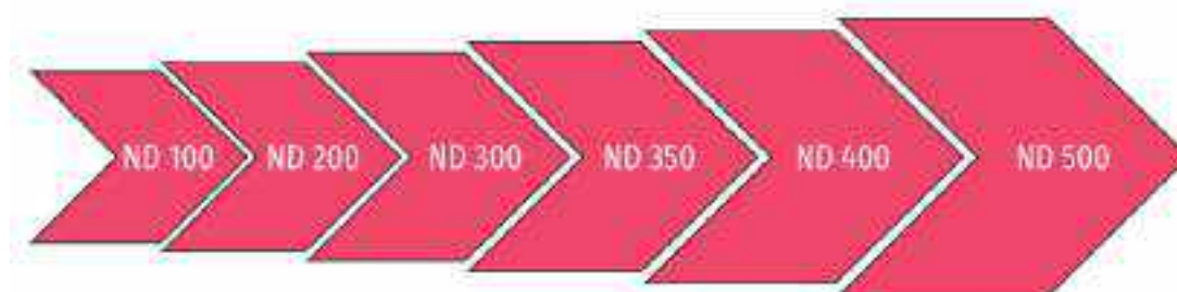
Figura 3 - Níveis de Desenvolvimento do Modelo BIM
