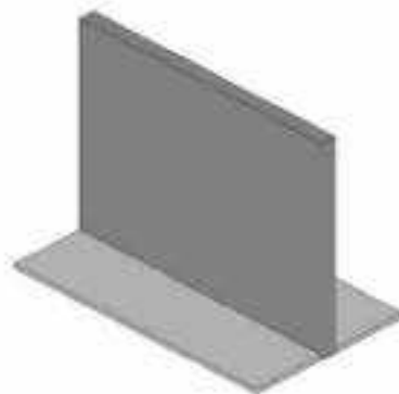
Figura 4 – LOD 100: Elemento de Parede arquitetônica
