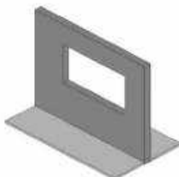
Figura 5 – LOD 200: Elemento de Parede arquitetônica
