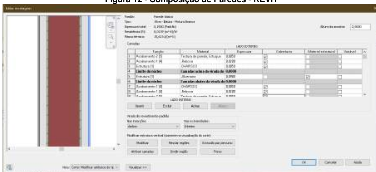
Figura 12 - Composição de Paredes - REVIT
